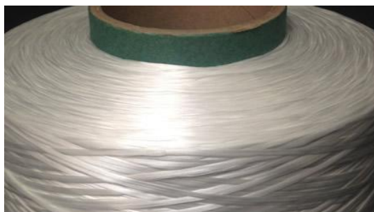
شکل 9: الیاف آب بندی
