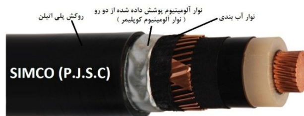
شکل 6: نمونه کابل تولید شده با آلومینیوم کویلر و روکش پلی اتیلن به همراه نوار نیمه هادی آب بندی بین آلومینیوم کویلر و اسکرین
